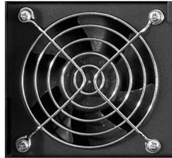
El funcionamiento intermitente del ventilador, alarga la vida útil del mismo y evita que los conductos interiores de refrigeración se obstruyan con facilidad. Según las condiciones de trabajo y del lugar de instalación, deberá realizarse una operación de limpieza interior regularmente, desmontando la tapa superior y eliminando los restos de polvo y suciedad. Es conveniente encargar esta operación a un servicio técnico autorizado.
